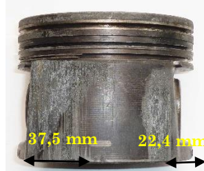
Gambar 2. Cacat/kerusakan pada A.1 dan A.2
