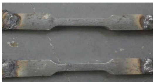
Gambar. 10 Material sebelum uji tarik pada suhu 600 °C
