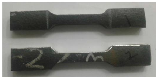
Gambar. 8 Material sebelum uji tarik pada suhu kamar
