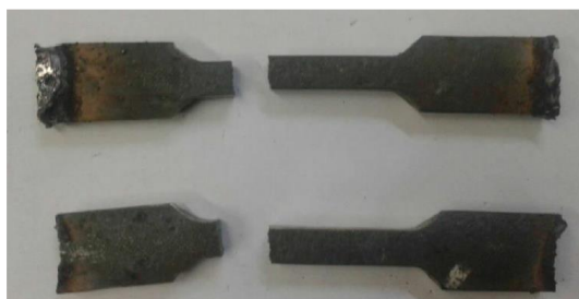
Gambar. 4.14 Material hasil uji tarik pada suhu 600 °C
