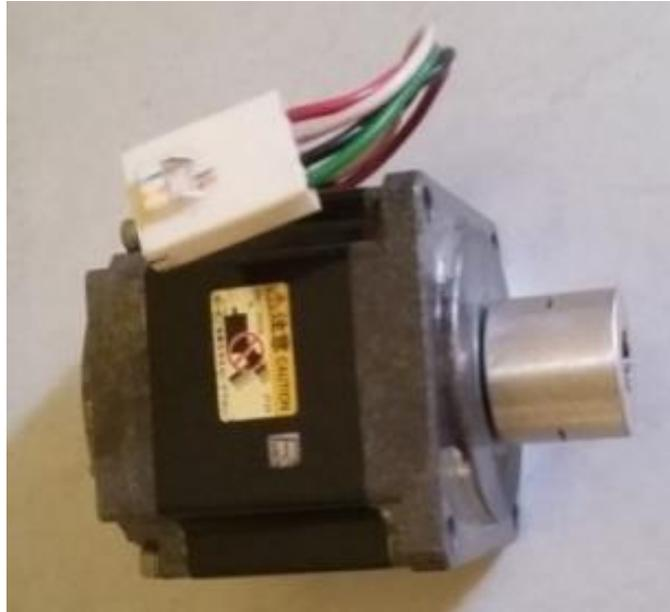
Gambar 4. Generator Magnet Permanen.
